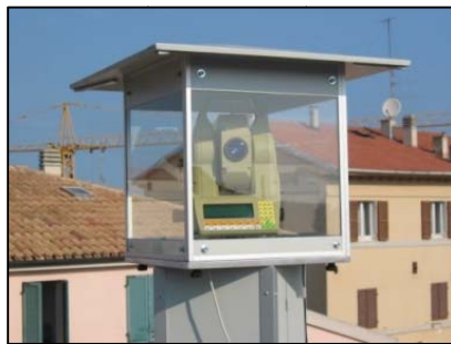
Monitoraggio topografico con stazione robotizzata ad altissima precisione
